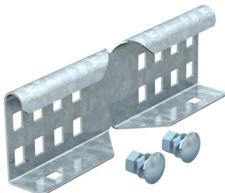
Winkelverbinder als Außenverbinder zur Verbindung von Kabelleitern und Formteilen mit 60 mm Seitenhöhe und durchgängiger Holmlochung. Die Durchgängigkeit des Potentialausgleichs ist durch die Verschraubung sichergestellt.
