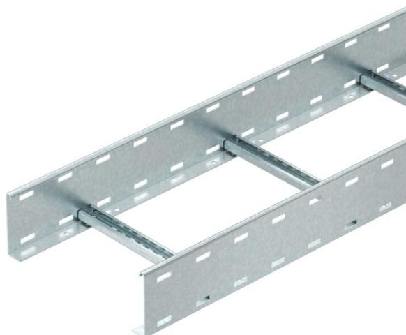
Kabelleiter in Seitenhöhe 110 mm mit eingeschweißten, nach oben offenen C30-Profil Sprossen. Eingerollter Seitenholm zur Verstärkung und als Kantenschutz. Die Befestigung auf dem Ausleger erfolgt mit Klemmstücken Typ LKS 40. Das Schlitzmaß der Sprosse beträgt 16,5 mm, die passende Bügelschelle ist der Typ 2056.
