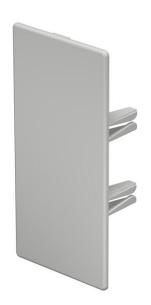
Endstück zum Verschließen der WDK-Kanäle. Die Endstücke werden auf den Kanal aufgedrückt und durch eine Federwirkung gehalten.
