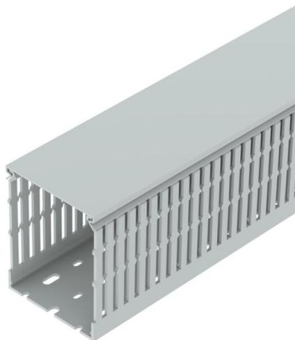
Halogenfreier Verdrahtungskanal inkl. Oberteil und Bodenlochung zur waagerechten und senkrechten Verlegung elektrischer Kabel und Leitungen im Schaltschrank. Mit doppelseitigen Klebeband am Kanalboden als Montagehilfe. Ausführung als metrischer Kanal. Das Ausbrechen der Stege erfolgt werkzeuglos. Sonderlängen auf Anfrage.
