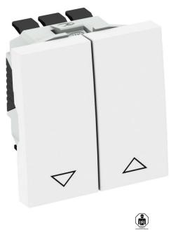
Rollladentaster mit elektrischer Verriegelung, 1-polig, 10 A, 250 V~, mit Steckklemmen
