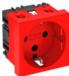
Schutzkontakt-Steckdose 1-fach 0°, kodierte Ausführung, mit erhöhtem Berührungsschutz, mit Steckklemmen, 2-polig, 16 A, 250 V~, mit Verbindungsklemmen nach IEC 60884-1.
