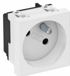
Steckdose mit Erdungstift 1-fach 33°, mit erhöhtem Berührungsschutz, mit Steckklemmen, 2-polig, 16 A, 250 V~, mit Verbindungsklemmen nach IEC 60884-1.
