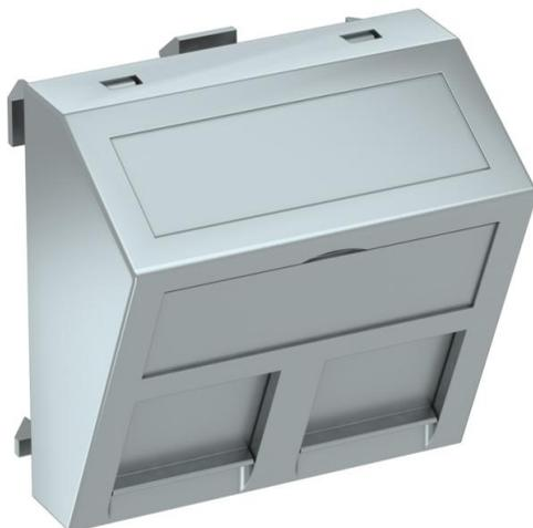
Datentechnikträger mit schrägem Auslass und Verschlusschieber zur Aufnahme von zwei Datentechnik-Anschlussmodulen mit RJ45-Buchse. Die Rastbefestigung eignet sich für den waagerechten und senkrechten Einbau in die Systemumgebung. Typ A hat eine Montageöffnung von 20,10 x 14,80 mm und ist für die direkte Befestigung der Daten-Anschlussmodule in der Montageöffnung ausgelegt.
