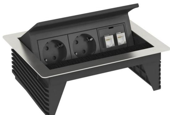
Klappbare Deskbox mit Anschlusskabel, für den festen Einbau in eine Tischplatte, Gehäuse aus gebürstetem Edelstahl mit Bürstenleiste als Leitungsauslass. Die Montage erfolgt über eine Einbauöffnung 195 x 157 mm in der Tischplatte.
