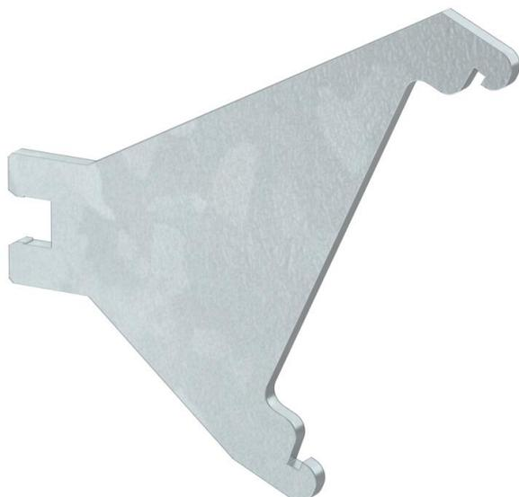
Stabilisatorblech zur Stabilisierung der Systemöffnung des Design-Geräteeinbaukanals Serie GAD. Das Blech wird im Kanalunterteil eingesetzt und unterstützt die Aufnahme von Oberteilen und sorgt für sicheren Halt der Einbaugeräte.
