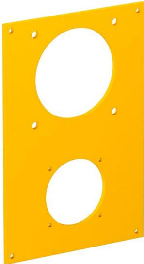
Abdeckplatte mit einer  $\varnothing$  45-mm-Öffnung zum Einbau einer Anbausteckdose (Typ ASD-...) mit 38-mm-Befestigungsspur und einer  $\varnothing$  60-mm-Öffnung zum Einbau einer CEE-Steckdose 16/32 A mit 60-mm-Befestigungsspur, inklusiv 8 Schrauben zur Gerätebefestigung.
