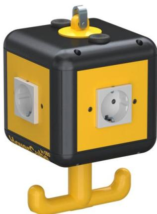
Gehäuse bestückt und vorverdrahtet mit Aufhängeöse, Griffhaken und 4 Abdeckplatten. Bestückt wie folgt: 4 x 1fach-Schutzkontakt-Steckdosen 16 A/250 V mit erhöhtem Berührungsschutz, auf zwei Wechselstromkreise vorverdrahtet, Anschluss über 2 x Klemmen 3-polig, mit Trennwand zur Stromkreistrengung.
