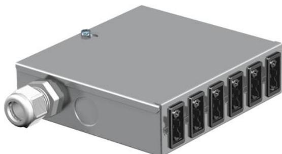
Energieverteiler für Starkstromtechnik mit Festanschluss, bestückt und vorverdrahtet. Eingang: 1x Dreiphasen-Stromkreis über einen schraubenlosen Steckklemmblock 5-polig für Leitungsquerschnitte 0,5 - 4 mm<sup>2</sup>. Ausgang: 6 selbstverriegelnde Steckverbinder 3-polig in schwarz, 16 A, Typ GST18i (Buchsenteil: 2 x L1, 2 x L2, 2 x L3). Verdrahtung intern: PVC-Aderleitung H07V-U2,5.
