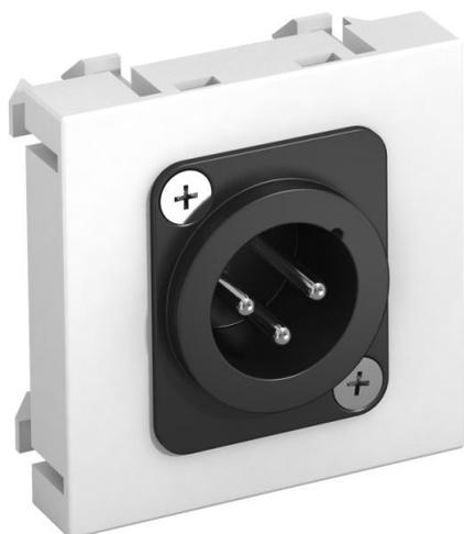
Multimediaträger mit einer XLR-Anschlussbuchse, Kabelauslass gerade, ohne Beschriftungsfeld, XLR-Stecker 3-polig mit Lötanschluss. Trägerplatte mit Rastbefestigung, geeignet für den waagerechten und senkrechten Einbau in die Systemumgebung.
