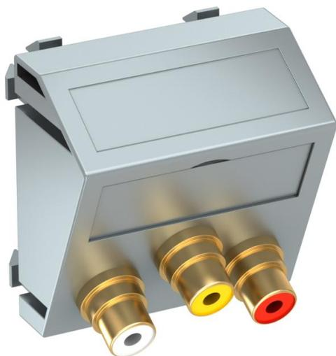
Multimediaträger mit drei Cinch-Anschlussbuchsen für Audio-Video, Kabelausschuss schräg, mit Beschriftungsfeld, drei Cinch-Kupplungen (RCA) in Ausführung Buchse-Buchse, Farbkodierung gelb/rot/weiß. Trägerplatte mit Rastbefestigung, geeignet für den waagerechten und senkrechten Einbau in die Systemumgebung.
