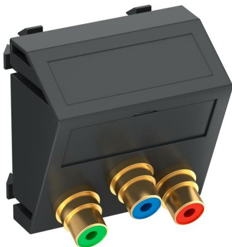
Multimediaträger mit drei Cinch-Anschlussbuchsen für Component Video, Kabelausschuss schräg, mit Beschriftungsfeld, drei Cinch-Kupplungen (RCA) in Ausführung Buchse-Buchse, Farbkodierung rot/grün/-blau. Trägerplatte mit Rastbefestigung, geeignet für den waagerechten und senkrechten Einbau in die Systemumgebung.
