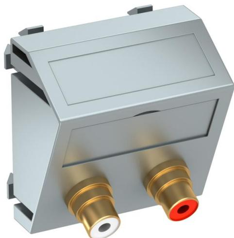
Multimediaträger mit zwei Cinch-Anschlussbuchsen für Audio R/L, Kabelauslass schräg, mit Beschriftungsfeld, zwei Cinch-Kupplungen (RCA) in Ausführung Buchse-Buchse, Farbkodierung rot/weiß. Trägerplatte mit Rastbefestigung, geeignet für den waagerechten und senkrechten Einbau in die Systemumgebung.
