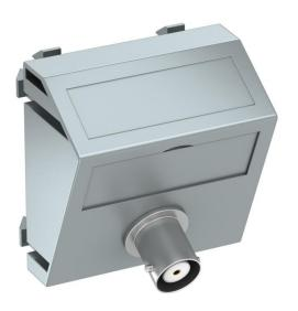
Multimediaträger mit einer BNC Anschlussbuchse, Kabelauslass schräg, mit Beschriftungsfeld, BNC Kupplung in Ausführung Buchse-Buchse. Trägerplatte mit Rastbefestigung, geeignet für den waagerechten und senkrechten Einbau in die Systemumgebung.
