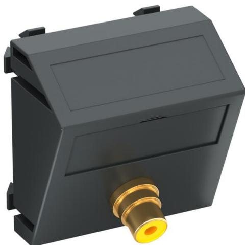
Multimediaträger mit einer Cinch-Anschlussbuchse für Composite Video, Kabelausschuss schräg, mit Beschriftungsfeld, Cinch-Kupplung (RCA) in Ausführung Buchse-Buchse, Farbkodierung gelb. Trägerplatte mit Rastbefestigung, geeignet für den waagerechten und senkrechten Einbau in die Systemumgebung.
