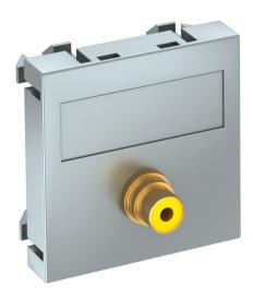
Multimediaträger mit einer Cinch-Anschlussbuchse für Composite Video, Kabelauslass gerade, mit Beschriftungsfeld, Cinch-Kupplung (RCA) in Ausführung Buchse-Buchse, Farbkodierung gelb. Trägerplatte mit Rastbefestigung, geeignet für den waagerechten und senkrechten Einbau in die Systemumgebung.
