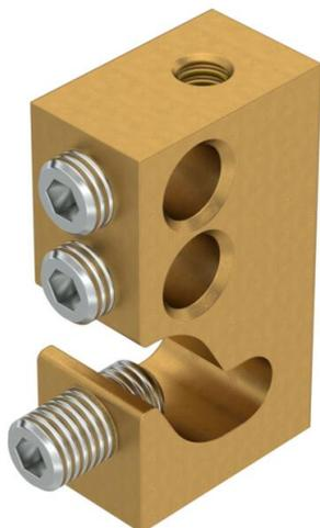
Einfache Anschlussklemme zur Aufnahme von 1 Leiterseil, zum Erstellen des Schutzpotentialausgleichs bei Kabeltragsystemen. Zur Direktmontage unterhalb der Kabelrinne mit Flachkopfschraube Typ FKS M6x12 geeignet. Leiterseil bis max. 35 mm<sup>2</sup>, empfohlene Aderendhülse von 6 mm<sup>2</sup> bis 35 mm<sup>2</sup> nach DIN 46228 Teil 4, Abisolierlänge 18 mm.
