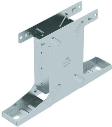
Unterteil der symmetrischen Bodenstütze für das BKRS-System, passend für Traverse Typ BSST 400/500/600. Einsetzbar für begehbare Kabelrinnen Breite 400-600 mm. Mit Gewindedurchzügen zum Montieren von Anschlussbauteilen, z. B. Rohrklemmen, sowie mit Langlöchern für Bodenmontage bis M10. Befestigungsmaterial muss separat bestellt werden.
