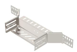
Anbau-Abzweigstück zum Erstellen einer horizontalen Abzweigung oder Kreuzung, Formteil für rast- und schraubbare Kabelrinnen Seitenhöhe 60 mm. Schraubenlose Montage mit Doppelklemmen oder Schraubverbindung mit Flachrundschrauben FRS und Kombimuttern M6. Einsetzbar im Innen- und Außenbereich. Befestigungsmaterial muss separat bestellt werden.
