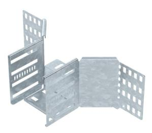
Anbau-Abzweigstück zum Erstellen einer horizontalen Abzweigung oder Kreuzung, Formteil für rast- und schraubbare Kabelrinnen Seitenhöhe 110 mm. Schraubenlose Montage mit Doppelklemmen oder Schraubverbindung mit Flachrundschrauben FRS und Kombimuttern M6. Einsetzbar im Innen- und Außenbereich. Befestigungsmaterial muss separat bestellt werden.
