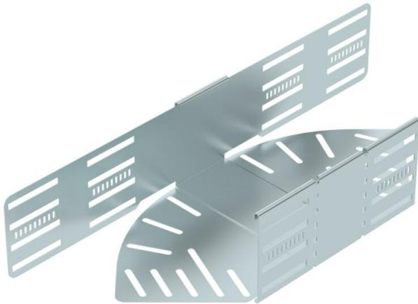
Winkelverstellbarer Bogen zum Erstellen einer horizontalen Abzweigung. Formteil für rast- und schraubbare Kabelrinnen Seitenhöhe 110 mm. Einstellbarer Winkel 0 - 90°. Schraubenlose Montage mit Doppelklemmen oder Schraubverbindung mit Flachrundschrauben FRS und Kombimuttern M6. Einsetzbar im Innenbereich. Befestigungsmaterial muss separat bestellt werden.
