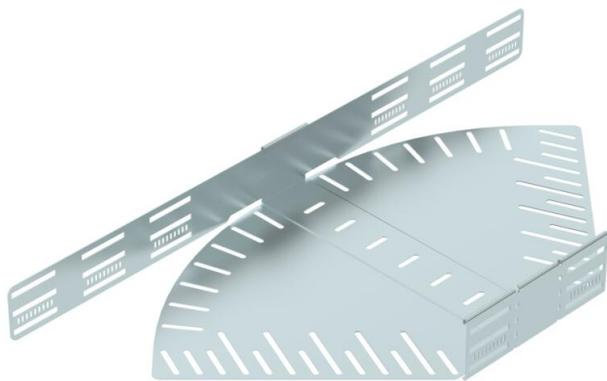
Winkelverstellbarer Bogen zum Erstellen einer horizontalen Abzweigung. Formteil für rast- und schraubbare Kabelrinnen Seitenhöhe 85 mm. Einstellbarer Winkel 0 - 90°. Schraubenlose Montage mit Doppelklemmen oder Schraubverbindung mit Flachrundschrauben FRS und Kombimuttern M6. Einsetzbar im Innenbereich. Befestigungsmaterial muss separat bestellt werden.
