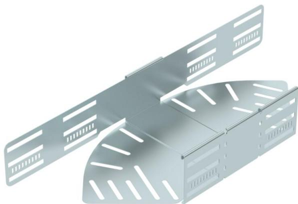
Winkelverstellbarer Bogen zum Erstellen einer horizontalen Abzweigung. Formteil für rast- und schraubbare Kabelrinnen Seitenhöhe 85 mm. Einstellbarer Winkel 0 - 90°. Schraubenlose Montage mit Doppelklemmen oder Schraubverbindung mit Flachrundschrauben FRS und Kombimuttern M6. Einsetzbar im Innenbereich. Befestigungsmaterial muss separat bestellt werden.
