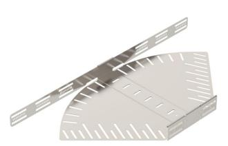
Winkelverstellbarer Bogen zum Erstellen einer horizontalen Abzweigung, Formteil für rast- und schraubbare Kabelrinnen Seitenhöhe 60 mm. Einstellbarer Winkel 0 - 90°. Schraubenlose Montage mit Doppelklemmen oder Schraubverbindung mit Flachrundschrauben FRS und Kombimuttern M6. Einsetzbar im Innenund Außenbereich. Befestigungsmaterial muss separat bestellt werden.
