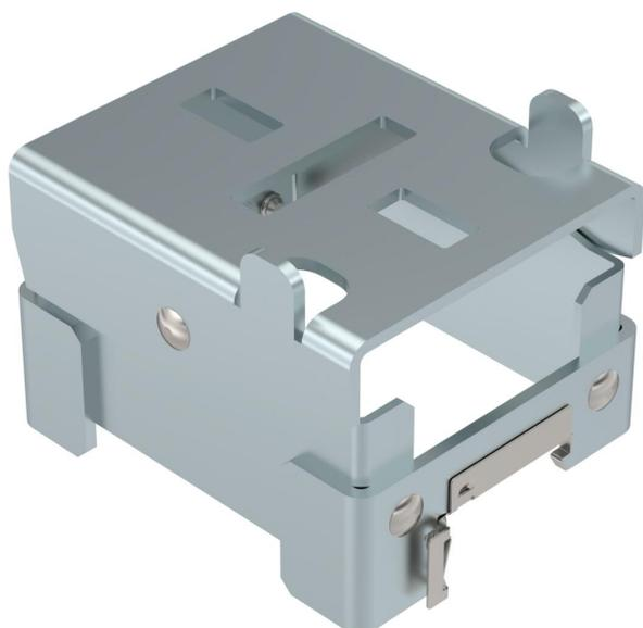
Kurze Stütze zum Montieren von Photovoltaik-Modulen auf Flachdächern in Kombination mit Trägerprofil TP 45/4700 und Universalklemme KLU. Neigungswinkel 15°. Rastbare Befestigung auf Trägerprofil.
