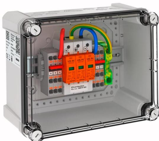
Generatoranschlusskasten Typ 1+2 für Photovoltaikanlagen zum Anschluss von 4 Strings. Zum DC-Schutz des Wechselrichters.
