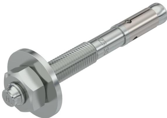
Bolzenanker BZ3 zur Verankerung mittelschwerer bis schwerer Lasten in gerissenem oder ungerissenem Beton. Geeignet für hohe Lasten mit geringen Rand- und Achsenabständen. Zum Einschlagen.
