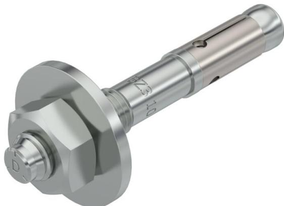
Bolzenanker BZ3 zur Verankerung mittelschwerer bis schwerer Lasten in gerissenem oder ungerissenem Beton. Geeignet für hohe Lasten mit geringen Rand- und Achsenabständen. Zum Einschlagen.
