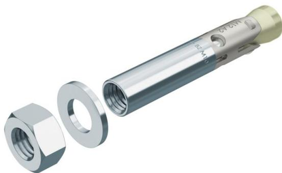
Bolzenanker BZ-IG mit Innengewinde zur Verankerung mittelschwerer bis schwerer Lasten, sowohl in gerissenen als auch ungerissenen Beton. Er vereint hohe zulässige Lasten mit geringen Rand- und Achsenabständen. Ein Hinterschnitt der Bohrlöcher ist nicht erforderlich.
