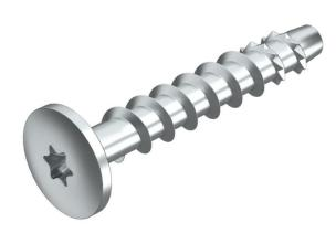
Schraubanker zur direkten Montage ohne Dübel in gerissenem und ungerissenem Beton sowie Mauerwerk. Mit großem Rundkopf für die Befestigung von Montage- und Profilschienen. Torx-Antrieb T30.
