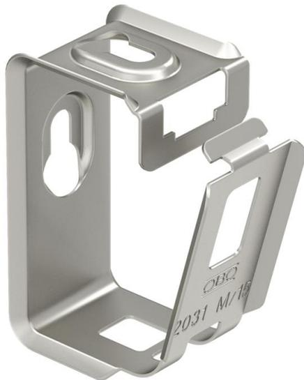
Sammelhalter aus Metall für hohe mechanische Standfestigkeit, auch im Brandfall. Zur sicheren Montage oberhalb von Brandschutzdecken geeignet. Auch als kabelspezifische Variante für den elektrischen Funktionserhalt nach DIN 4102 Teil 12 zugelassen. Für Wand- und Deckenmontage. Verschluss ohne Werkzeuge zu öffnen.
