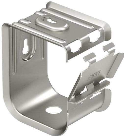
Sammelhalter aus Metall für hohe mechanische Standfestigkeit, auch im Brandfall. Zur sicheren Montage oberhalb von Brandschutzdecken geeignet. Auch als kabelspezifische Variante für den elektrischen Funktionserhalt nach DIN 4102 Teil 12 zugelassen. Für Wand- und Deckenmontage. Verschluss ohne Werkzeuge zu öffnen.
