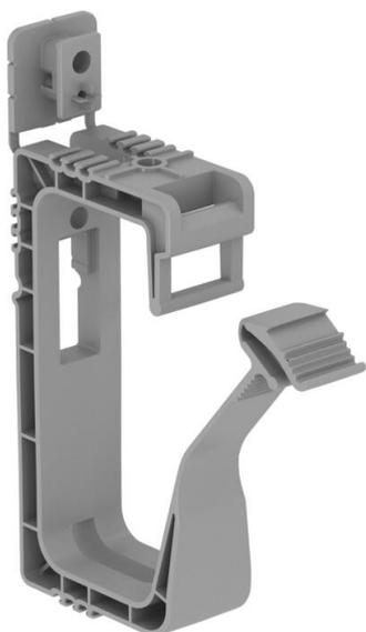
Sammelhalterung mit angespritztem Befestigungselement, zum Montieren von bis zu 40 Leitungen NYM 3 x 1,5 mm<sup>2</sup> an Wand oder Decke. Befestigung mit Schlagdübel oder Steckdübel. Befestigungsloch Ø 6 mm. Empfohlener Befestigungsabstand bei voller Belegung 250-400 cm, abhängig von den jeweilig gültigen nationalen Vorgaben/Normen. Flammwidrig nach DIN VDE 0471/DIN IEC 695 Teil 2-1, Prüftemperatur 960°C.
