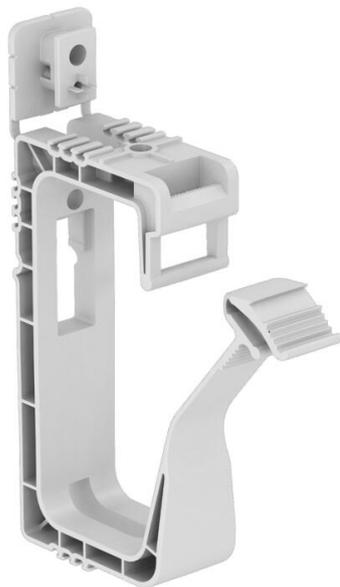
Sammelhalterung für die allgemeine Anwendung mit Befestigungslöchern 6 mm Ø, geeignet für Wand- und Deckenmontage. Das angespritzte Befestigungselement kann mit Schlagdübel oder Gasdrucknagelgerät befestigt werden. Der empfohlene Befestigungsabstand bei voller Belegung beträgt 250 - 400 mm. Mit multifunktionalem Befestigungselement.
