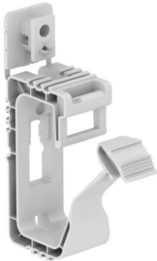
Sammelhalterung für die allgemeine Anwendung mit Befestigungslöchern 6 mm Ø, geeignet für Wand- und Deckenmontage. Das angespritzte Befestigungselement kann mit Schlagdübel oder Gasdrucknagelgerät befestigt werden. Der empfohlene Befestigungsabstand bei voller Belegung beträgt 250 - 400 mm. Mit multifunktionalem Befestigungselement.
