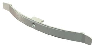
Kabelklammer zum Montieren von bis zu 10 Leitungen NYM 3 x 1,5 mm<sup>2</sup> z. B. an Zwischenwänden oder -decken. Geeignet zum Befestigen mit gas- und akkubetriebenen Setzgeräten der Marken Bosch, Fischer und Spit (Nasendurchmesser außen Ø 11 mm). Klemmhöhe 9 mm, mit Distanzstück 13 mm. Befestigungsloch Ø 7 mm.
