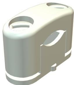
Mit Kunststoffschrauben, daher korrosionssicher, mit Langloch zur Befestigung mittels Holzschrauben oder Schlagdübel 5 mm. Schwer entflammbar.
