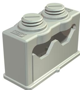
Solide Kabelbefestigung durch Klemmschrauben, mit Klebefuß, Langloch und zum Aufschrauben auf Gewinde M6. Zum Kleben der Polystyrol-Schellen auf Mauerwerk und Beton Impu-Fix-Stegleitungs-Schnellkleber Typ 509 verwenden.
