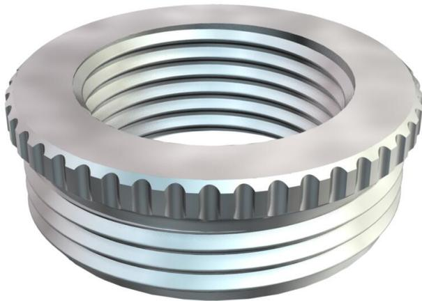
Reduktion (Teil H) nach DIN 46320, mit PG-Gewinde nach DIN 40430, zum Übergang von einem PG-Gewindeloch auf eine kleinere Kabelverschraubung. \* Preise laut DEL-Notierung.
