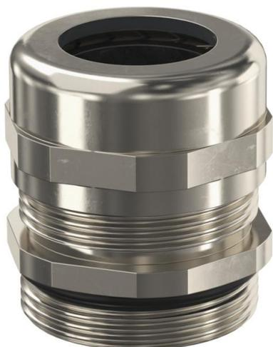
Robuste Kabelverschraubung mit metrischem Anschlussgewinde nach IEC 423 in Hutmutterbauart für hohe Dichtigkeitsansprüche. Zugentlastung, Verdreh- und Dichtigkeit über den gesamten Spannbereich. Dichtring aus Neopren. Klemmeinsatz aus Polyamid. Mit vormontiertem Dichtring am Anschlussgewinde, VDE-geprüft nach DIN EN 50262, Schutzart IP68 bei 5 bar/1h, Temperatureinsatzbereich -20 bis +100°C.
