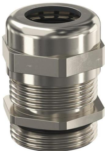
Robuste Kabelverschraubung mit metrischem Anschlussgewinde nach IEC 423 in Hutmutterbauart für hohe Dichtigkeitsansprüche. Zugentlastung, Verdreh- und Dichtigkeit über den gesamten Spannbereich. Dichtring aus Neopren. Klemmeinsatz aus Polyamid. Mit vormontiertem Dichtring am Anschlussgewinde, VDE-geprüft nach DIN EN 50262, Schutzart IP68 bei 5 bar/1h, Temperatureinsatzbereich -20 bis +100°C.
