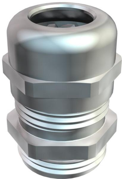
Kabelverschraubung in Hutmutterbauart mit großem Dichtbereich sowie Zugentlastung und Verdrehenschutz für hohe Dichtigkeitsansprüche, mit PG-Anschlussgewinde nach DIN 40430. Klemmeinsatz aus Polyamid, Dichtring aus Chloropren-Nitrilkautschuk, mit vormontiertem O-Ring am Anschlussgewinde. Schutzart IP68 bei 5 bar/1 h, geprüft nach DIN EN 62444. Anschlussgewindelänge „normal“, in Anlehnung an DIN 46320.
