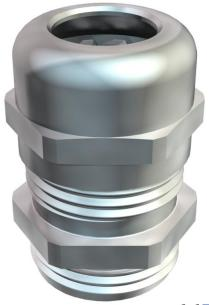
Kabelverschraubung in Hutmutterbauart mit großem Dichtbereich sowie Zugentlastung und Verdrehschutz für hohe Dichtigkeitsansprüche, mit PG-Anschlussgewinde nach DIN 40430. Klemmeinsatz aus Polyamid, Dichtring aus Chloroprene-Nitrilkautschuk, mit vormontiertem O-Ring am Anschlussgewinde. Schutzart IP68 bei 5 bar/1 h, geprüft nach DIN EN 62444.
