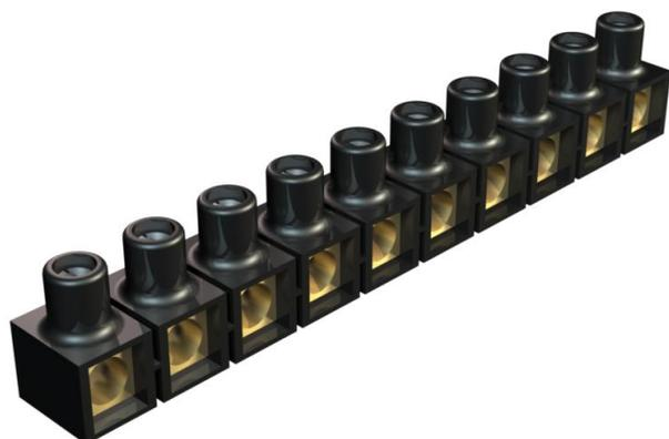
Klemmen Messing, Schrauben Stahl, galvanisch verzinkt und transparent passiviert, 10-polige, in Einzelklemmen abtrennbare Leiste, beidseitig offen. Schrauben hochgedreht, unverlierbar. Nennquerschnitt 10 ÷ mm<sup>2</sup> Nennspannung 380 V Max. anschließbare Querschnitte je Klemmstelle: 3 x 10 mm<sup>2</sup>, 4 x 6 mm<sup>2</sup>.
