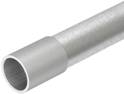
Elektroinstallationsrohr nach EN 61386-1, mit Gewindeenden nach DIN EN 60423, für den mechanischen Schutz von Kabeln und Leitungen. Mit gratfreier Innenwand. Korrosionsschutzklasse 4 (hoch). Pro Rohr ist bereits eine Verbindungsmuffe aufgeschraubt.
