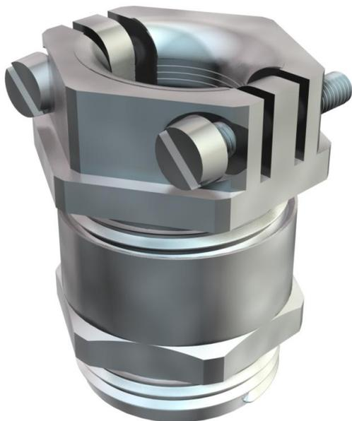
Kabelverschraubung mit zentrisch wirkender Querbügel-Zugentlastung in der Druckschraube, Biegeschutz beweglicher Leitungen durch stark gerundete Druckschraube. Mit PG-Anschlussgewinde nach DIN 40430. Druckringe Stahl, galvanisch verzinkt und transparent passiviert. Dichtring aus NR/SBR. Schutzart: mit Anschlussgewinde-Dichtring IP65, ohne Anschlussgewinde-Dichtring IP54. Mit Sechskant-Zwischenstutzen (ähnlich Form C 4 nach DIN 46320). \* Preise laut DEL-Notierung.
